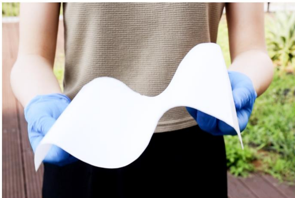
▲「超冷奈米纖維」以陶瓷製成，材料輕薄可彎曲、不易破損且耐酸雨。（圖／清大提供）
