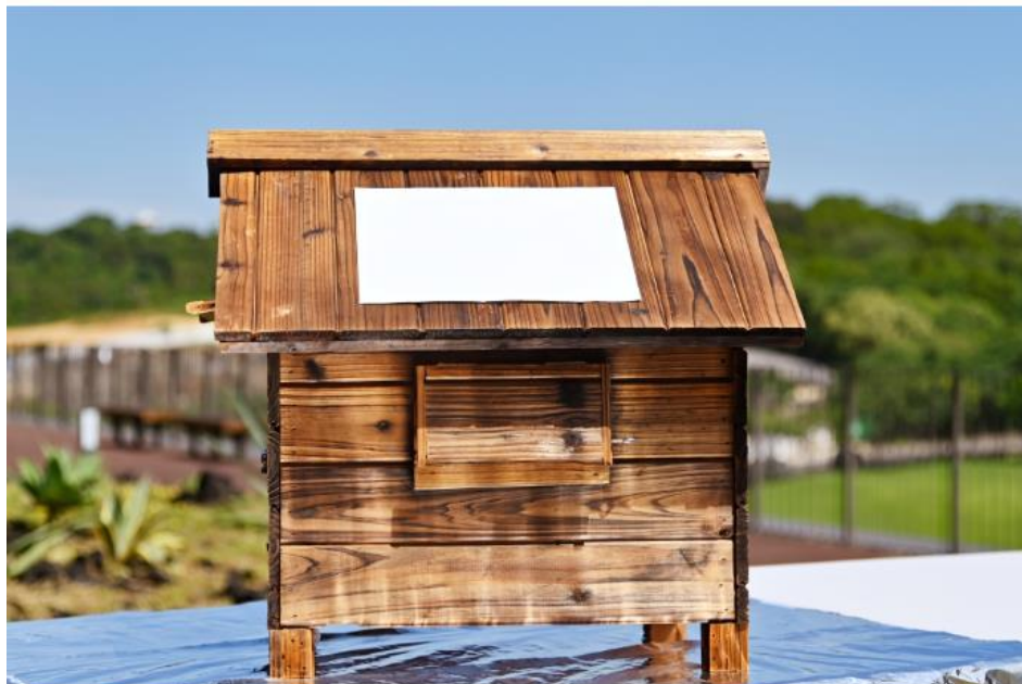
▲將超冷奈米纖維鋪在模型屋屋頂，溫度即從攝氏50度降到29度。(圖/清大提供)
