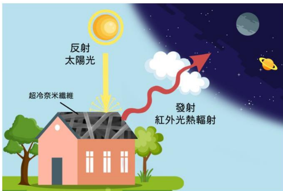
超冷奈米纖維能反射97%太陽光，並將熱能轉為紅外光，輻射到外太空。 圖片來源：清大
