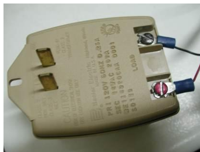
整流器，AC 110V 60Hz → DC 14V
