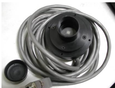
CCD 本體 192 x 165 像素 等效 ISO 20000 感光晶片
