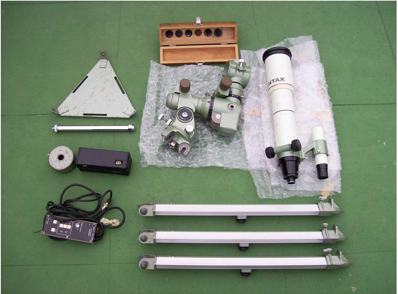
首先，利用這套儀器出外觀測，這些是最基本的配備，包含了 Ms-3n 赤道儀(重鎚、控制盒)、75SD 鏡筒、三角架(三角盤)、以及日規目鏡。以下將介紹如何架設這套儀器，來進行一般的天文觀測。
