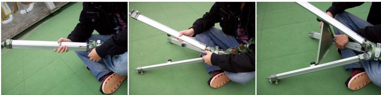
然後把赤道儀連同腳架整個直立起來，確認赤道儀基座與三角架接穩之後，將所有鬆動的螺絲鎖緊，這樣一來就完成了(如下圖)。
