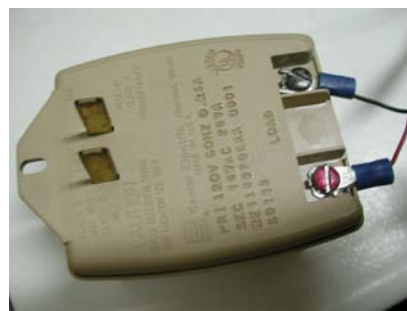
圖 2.6 整流器，AC 110V 60Hz→DC 14V
