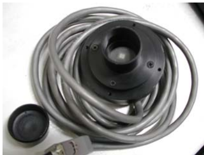
圖 2.1 CCD 本體 192 x 165 像素 等效 ISO 20000 感光晶片
