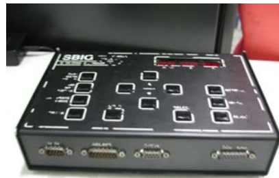
圖 2.2 控制盒 共有四個接口，注意使用時非常燙，如在平地，建議留心散熱問題以免用久了可能當機。
