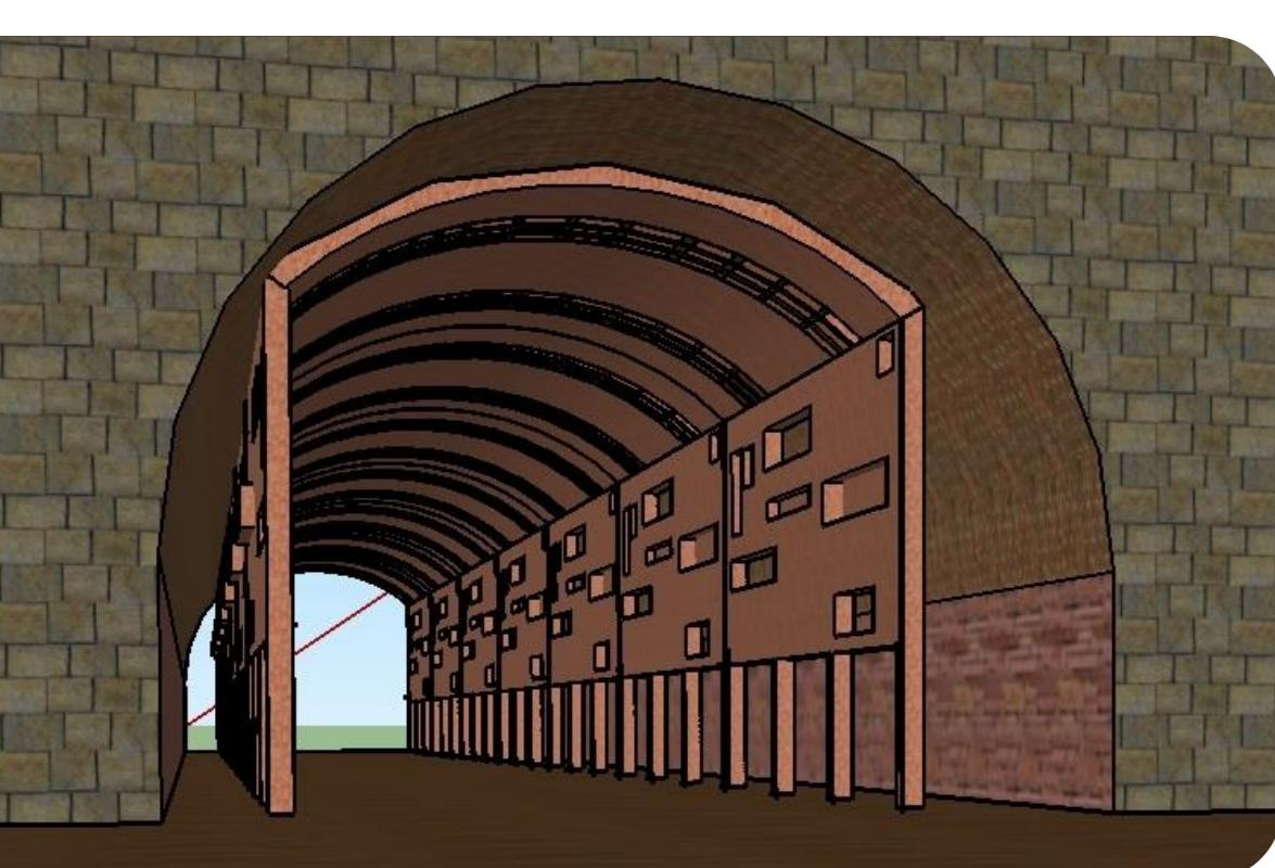
在不破壞原有建築的前提下，在隧道的內側另外築起一個拱形的廊道，此廊道採用不規則的內凹設計，分為簍空及內凹的設計，能夠營造營造出藏書閣的意象。內凹的部分代表書架，而簍空的部分則可以同時看到隧道本體的磚頭，透過這個設計能夠更凸顯整個隧道的歷史感。
