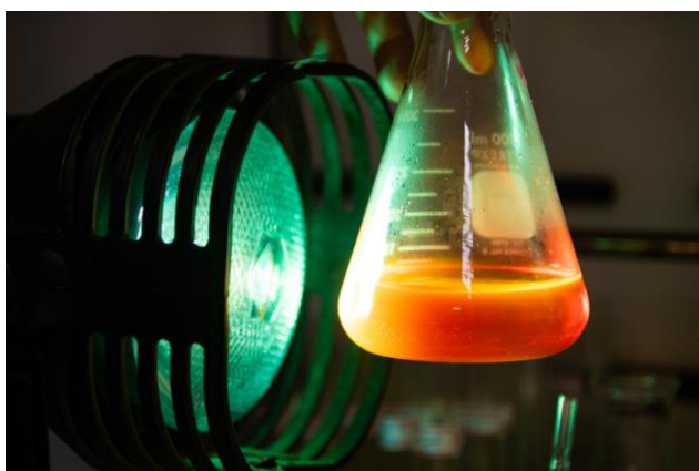
臭氧在紫外光照射下與水分子反應，產生氫氧自由基，可分解瓶中的持久性有機污染物。
