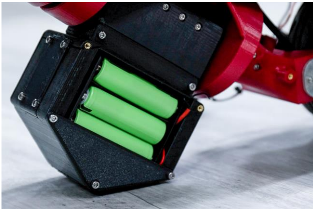
自動平衡摩托車的供電電池也兼作為平衡的配重塊。
