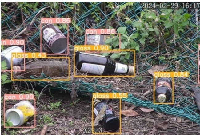
本校黃能富教授團隊訓練出的 AI 系統成功辨識出攝影機拍到的紙杯、鋁罐和玻璃瓶等河川廢棄物。
