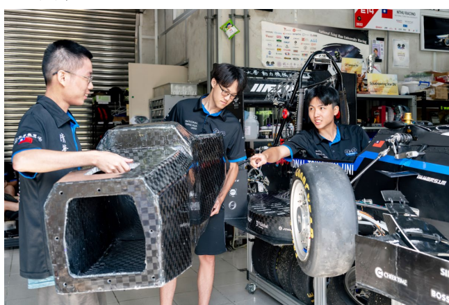
清大賽車工廠自製碳纖單體殼，期望減輕車輛重量。
