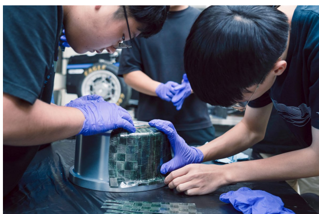
清大賽車工廠打造第一組由台灣學生團隊自製的輕量化碳纖輪框。
