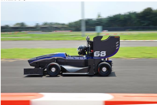
清大賽車工廠新車 THX 以自製碳纖維單體殼打造車身，整車減重 40 公斤、降至 220 公斤，性能全面升級。
